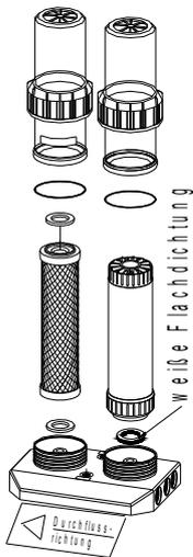
Bild 1: Einbau im DUO-HP
