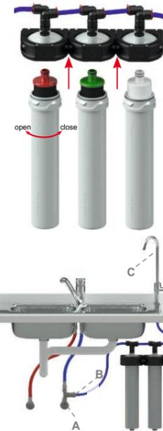
**6** Nehmen Sie die Kopfbaugruppe (1) wieder von der Wand. Stecken Sie nun die separat erworbenen Filterpatronen in die Kopfbaugruppe (1) und verschließen das Filtergerät mit den Filtertassen (4) (Bajonettverschluss mit 1/4 Umdrehung nach rechts). Hängen Sie nun das komplette Filtergerät wieder an die Wand.
